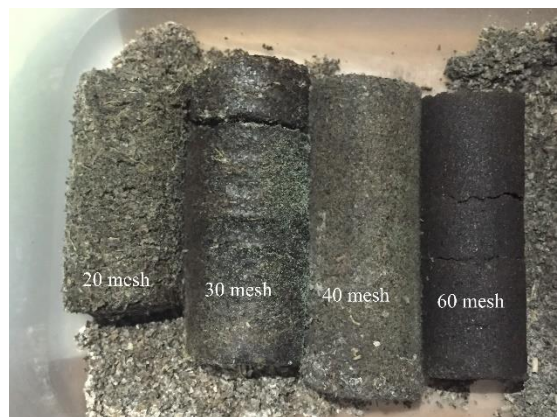
Gambar 6 Briket dengan tekanan press 10 bar (1MPa)
