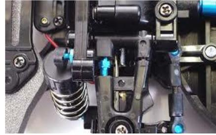
Gambar 2. Mekanisme Turn Buckle
