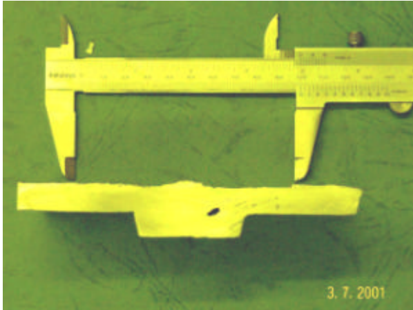
Gambar 5. Cacat Penyusutan pada Produk Cor dengan Riser Model I
