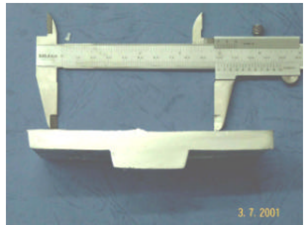
Gambar 7. Produk Cor Tanpa Cacat Penyusutan dengan Riser Model III
