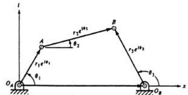
Gambar 3. Mekanisme Empat Batang Dinyatakan Dalam Bentuk Vektor [2].
