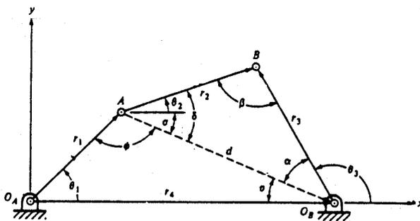
Gambar 2. Mekanisme Empat Batang dan Parameternya [2].
