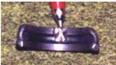
Gambar 14. Foto Cacat pada Lintasan Luar
