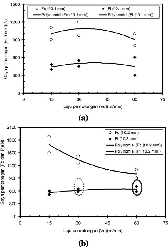
**Gambar 4.** Plot Laju Pemotongan ( $V_c$ ) vs. Gaya Pemotongan ( $F_c$  dan  $F_f$ ): (a) Untuk pemakanan ( $f$ ) 0.1 mm dan sudut geram pahat ( $\gamma$ )  $0^\circ$ , dan (b) Untuk pemakanan ( $f$ ) 0.2 mm dan sudut geram pahat ( $\gamma$ )  $0^\circ$ .
