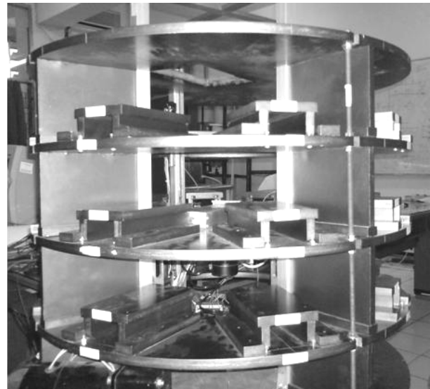
Gambar 5. Model Miniatur Tempat Parkir Otomatis
