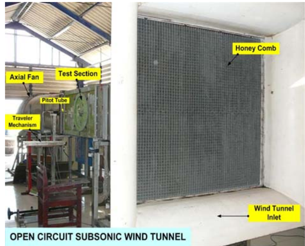
a. Penempatan Alat Ukur pada Open Circuit Subsonic Wind Tunnel
