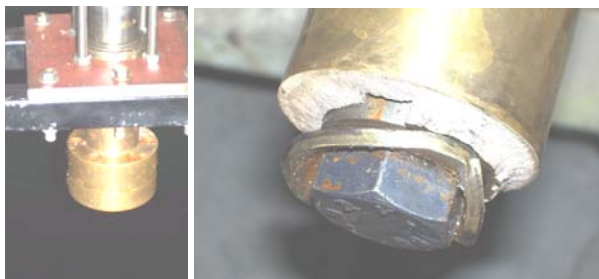
Gambar 10. Efek Fluktuasi Gaya Dengan Pengujian Towing Tank
