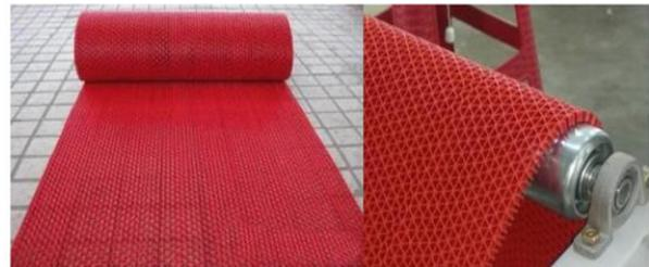
**Gambar 2.** Polyvinyl chloride (PVC) anti-slip mat yang digunakan sebagai material konveyor
