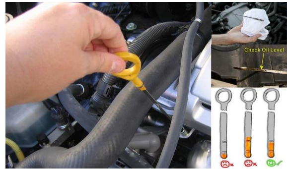
Gambar 2. Pengecekan level oli.
