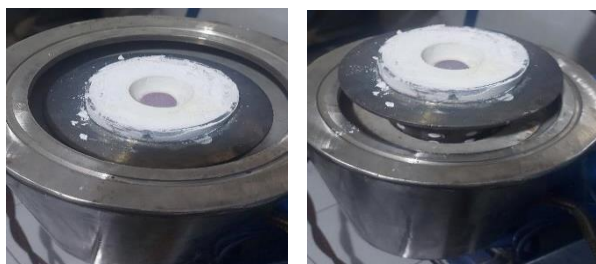
Gambar 9. Posisi Flask Awal dan setelah Pengecoran serta Ketika diangkat Pneumatic ke-2
