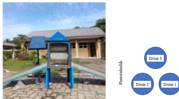
Gambar 7. a. Pengering rotari hasil rancang bangun dan b. Posisi drum pemutar
