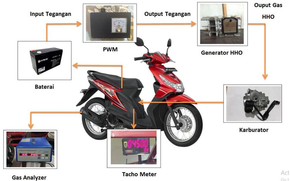
Gambar 1. Setting peralatan pada saat pengujian
