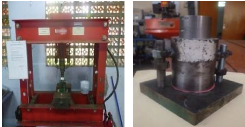
Gambar 2. Proses Kompaksi Komposit
