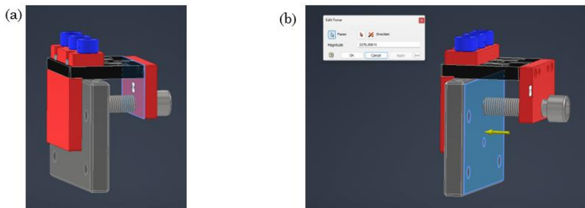
Gambar 6. Ilustrasi setup simulasi CAE; (a) Titik tumpu simulasi, (b) Titik gaya penekanan
