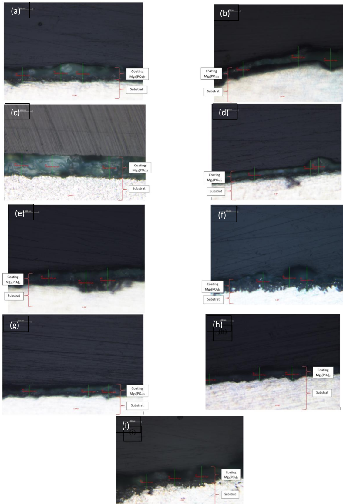
Gambar 2. Hasil pengamatan metalografi lapisan PCC pada paduan magnesium AZ91 dengan variasi pH dan temperatur proses pelapisan: (a) pH 2,5 - T 40 °C; (b) pH 2,5 - T 60 °C; (c) pH 2,5 - T 80 °C; (d) pH 3,0 - T 40 °C; (e) pH 3,0 - T 60 °C; (f) pH 3,0 - T 80 °C; (g) pH 3,5 - T 40 °C; (h) pH 3,5 - T 60 °C; (i) pH 3,5 - T 80 °C
