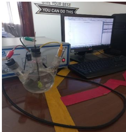
Gambar 1. Pengujian korosi menggunakan metode potentiodynamic polarization dengan konfigurasi tiga elektroda ( working electrode , reference electrode , dan counter electrode )
